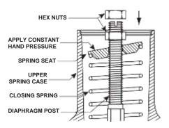
LOCKING DOWN THE SPRING SEAT TO FACILITATE INSTALLING THE HEX NUTS
