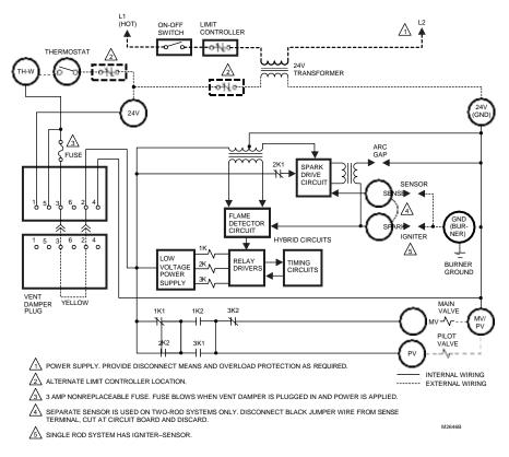
Fig. 8. Schematic for S8610U.
