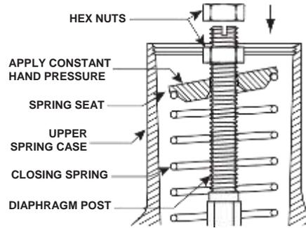
**LOCKING DOWN THE SPRING SEAT TO FACILITATE INSTALLING THE HEX NUTS**
